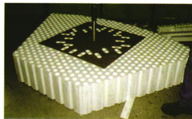
图3 炉箅子消失模模样
