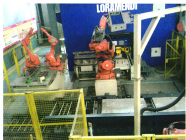
修芯、组芯机器人
