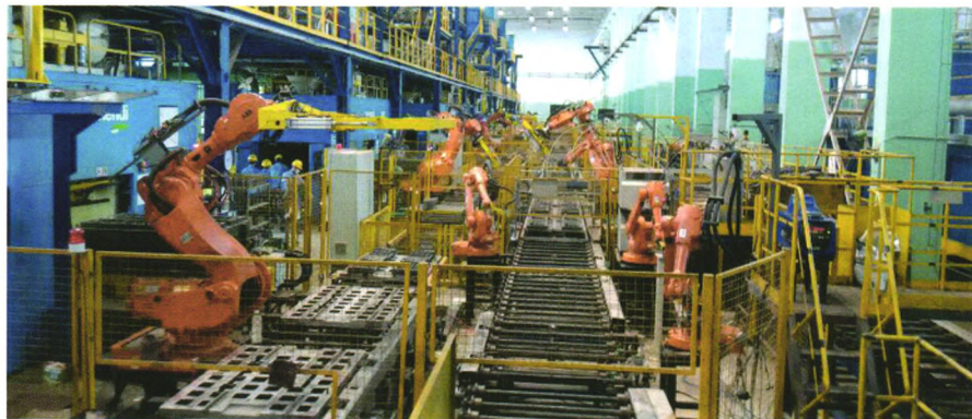
图1 制芯机器人作业现场
