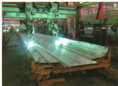
图4 龙门式IGM机械手的双焊枪同时焊接侧墙内侧焊缝
