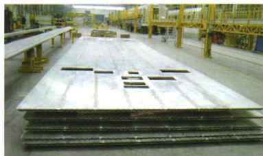
图6 龙门式IGM机械手焊接完的底架地板
