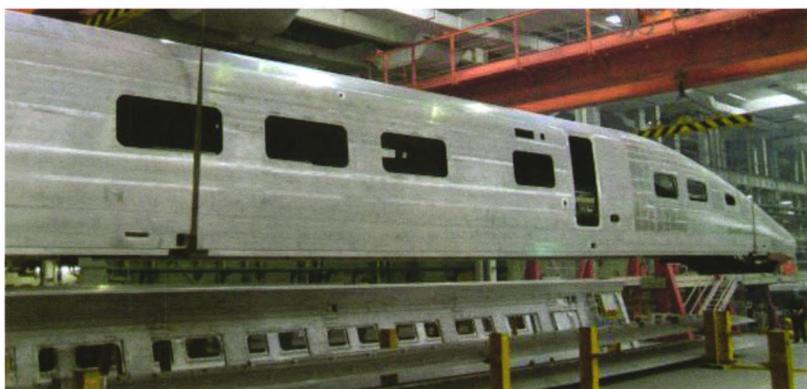
图1 正在起吊的带司机室的车体总组成
