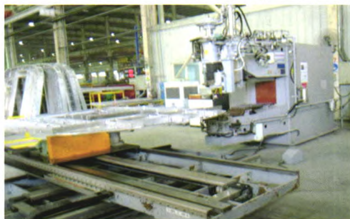
图8 电阻点焊端墙的骨架与外板
