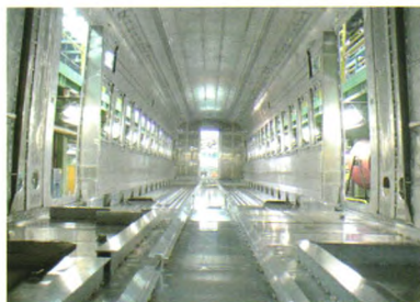
图2 完成焊接后的车体内部结构
