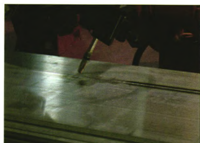
图11 铝合金空调板激光MIG复合焊接过程
