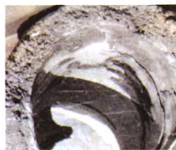
图11 型壳面层大面积剥落
