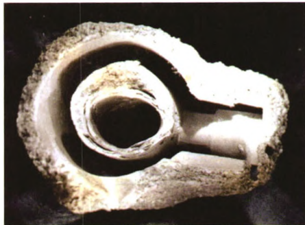
图5 一个型壳同时出现三种分层缺陷
