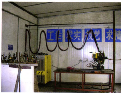
图1 MZ1000A/1250A SAW单机头 预热焊接测温试验
