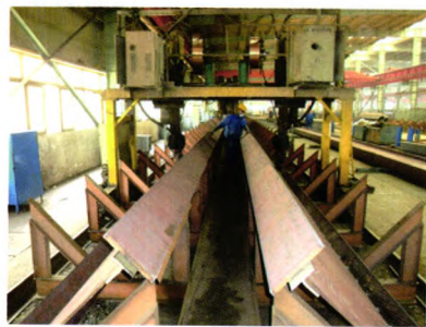
图2 MZ1250双机头SAW在H型 工字梁上的预热焊接
