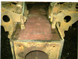
图7 双机头双丝SAW的焊接工艺性预热焊接
