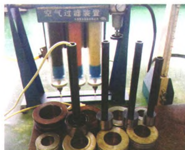
图5 检测缸孔与曲轴孔气动量仪
