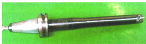
图4 粗镗曲轴孔防振镗刀
