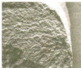
图2 活塞燃烧室喉口热疲劳裂纹SEM照片
