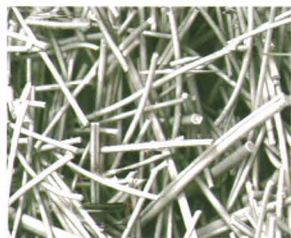
图1 SEM拍摄的陶瓷纤维预制件微观形貌
