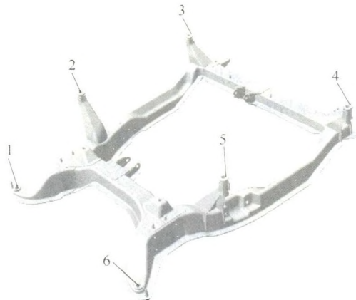
图1 前副车架结构 1~6.安装点
