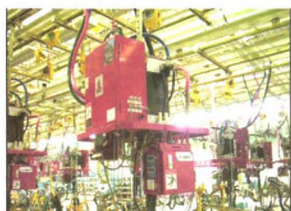
图1 PLC外挂焊点计数器
