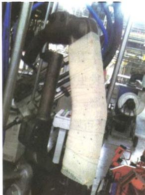
图7 防分流焊钳胶带
