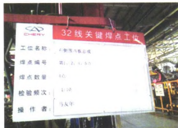
图9 关键焊点目视板
