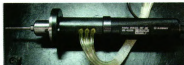
图7 测量座圈的圆度和跳动量的测头
