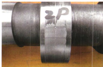
图2 凸轮轴磨损宏观照片
