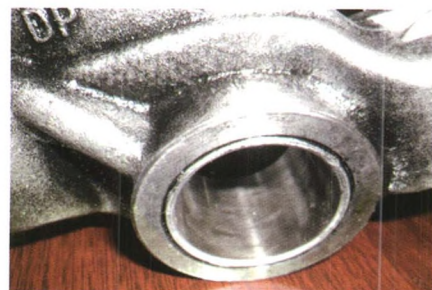
图3 摇臂衬套磨损宏观照片
