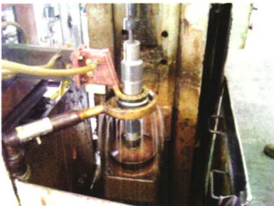
图1 分段扫描式感应加热淬火加工
