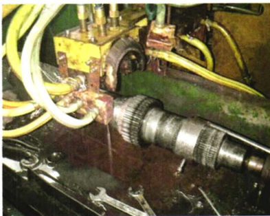
图2 分段整体式感应加热淬火
