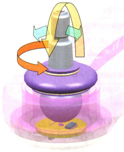
图2 球铰链三个旋转自由度
