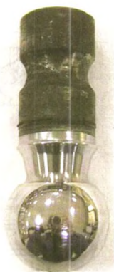
图5 密封试验后球销杆部腐蚀严重
