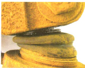
图3 密封试验后防尘罩与转向节间的间隙
