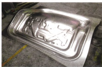
图4 比亚迪S6车型后备门内板件
