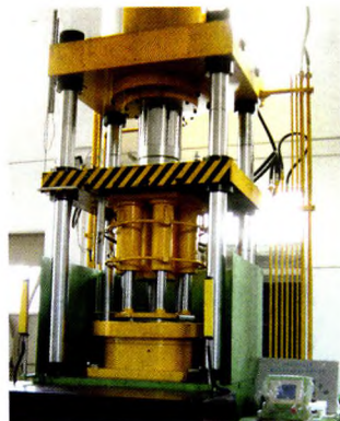
图1 北京航空航天大学研制的充液拉深设备
