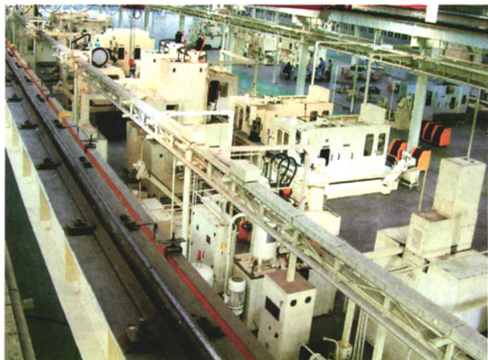
图4 国产缸体柔性加工自动线
