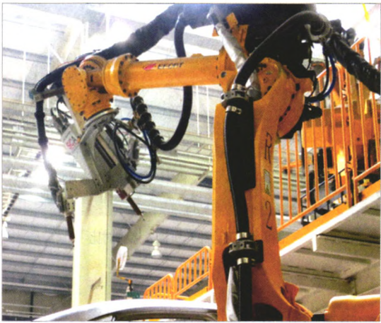
图4 机器人现场涂胶状态
