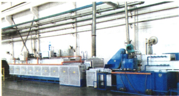
图2 气门挺柱淬火炉
