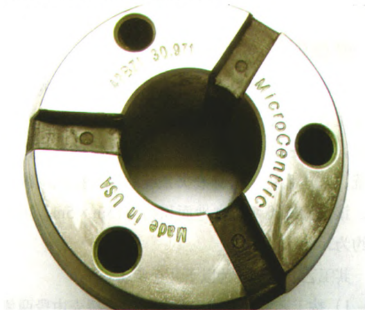
图3 气门挺柱磨内圆端面夹具
