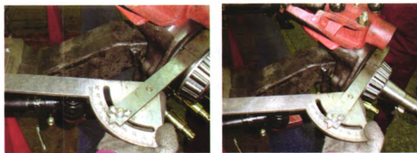
图4 前桥转向角度检测验具实物示意
