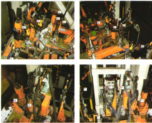
图2 三坐标标定情况及总拼夹具支撑面调整方案
