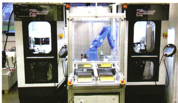
德国DEGEN公司研发的Vision Ultimate智能化高速珩磨机
