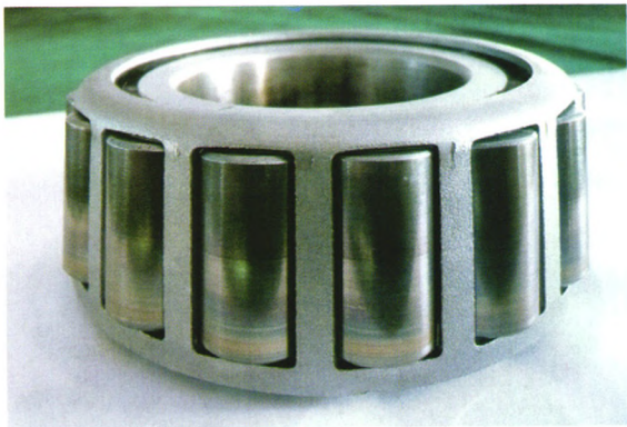
图3 滚子外径全部严重变色
