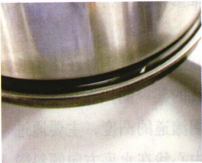
(c) 内圈大油沟轴向尺寸偏大
