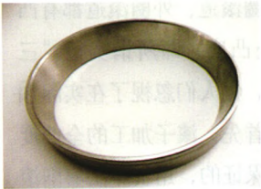
(a) 外圈滚道完好无损
