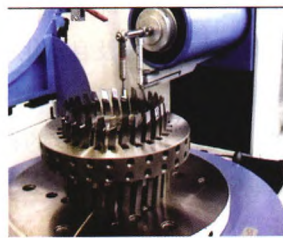
图3 CS200装刀机刀条 实现半自动安装
