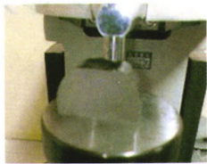
图7 试块硬度检验部位
