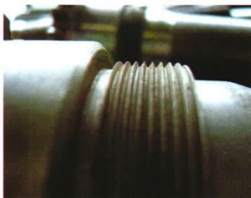
图1 螺纹根部出现明显的锈迹
