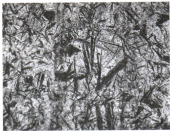
图4 失效主动齿轮过渡区金相组织（450×）
