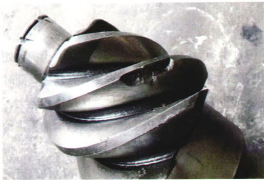
图3 失效主动齿轮宏观形貌
