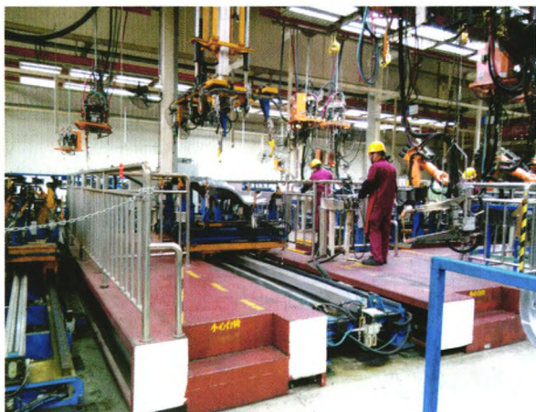
图3 车身工序定位切换机构
