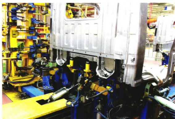
图5 多车型共用后卧铺总成吊具
