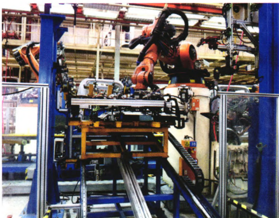
图6 车身总拼切换机构
