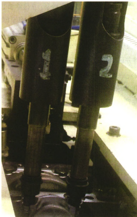
图2 连杆螺栓装配及拧紧示意
