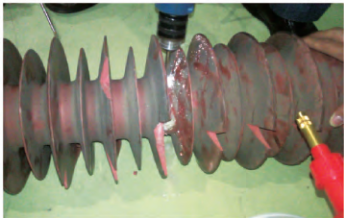
图 6 避雷器外绝缘损坏试品
