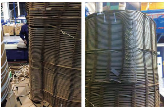
图 4 C 相中压线圈变形情况
