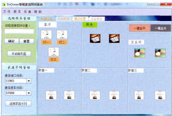
图6 系统中心控制单元软件主界面
