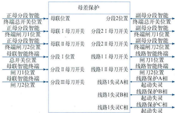
图4 虚端子展示——端子排连接图
