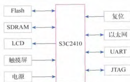
图1 核心电路连接图
