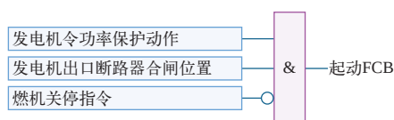
图3 起动FCB逻辑（未配置安全稳定装置）
