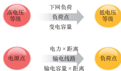
图2 输电线路与变压器对照图
