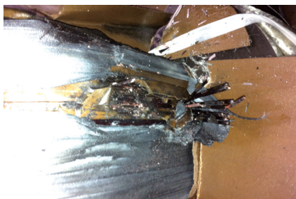
图4 C相线圈外侧熔断
