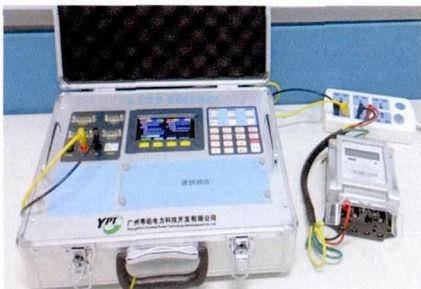
图7 载波电能表通信调试
