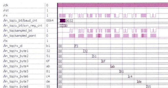
图6 LIN总线从控制器的接收报文仿真波形
