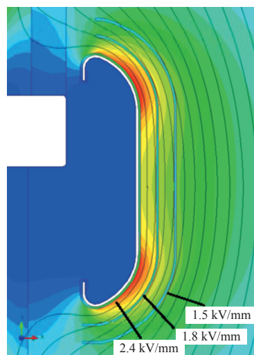
图12 加封绝缘挡板的油中均压罩的电场解析
