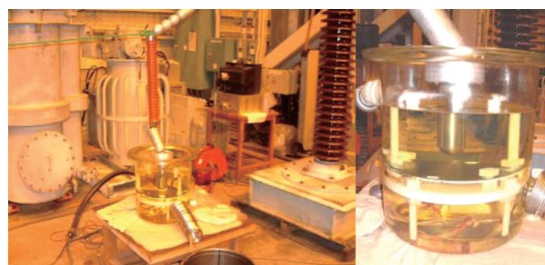
图6 油中混杂金属异物的耐压试验
