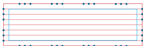
图 垂直接地极安装位置示意图
