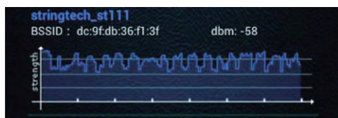
图6 现场无线信号强度测试结果
