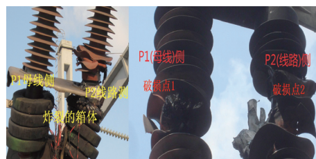
图2 电流互感器故障点
