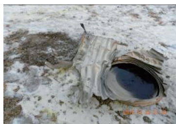
图6 5033A相电流互感器膨胀器及储油柜炸开
