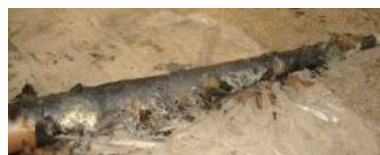
图8 5033A相电流互感器器身铝管绝缘表层烧损
