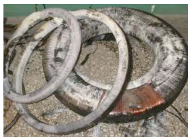
图7 5033A相电流互感器铁心与二次绕组
