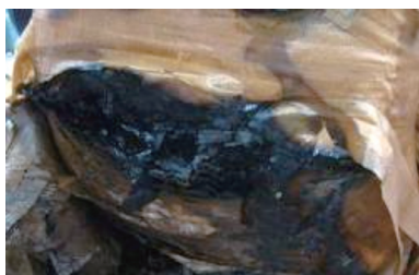
图9 5033A相电流互感器环部主绝缘放电击穿
