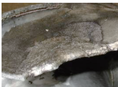
图10 5033A相电流互感器环部地屏放电点
