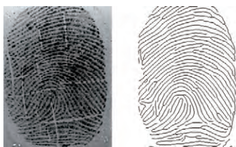
图4 原指纹图像(左)和预处理的指纹图像(右)
