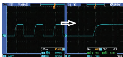
图1 TTL电平调制方波激光信号
