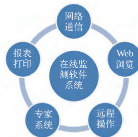
图1 中压开关柜在线监测软件系统的功能
