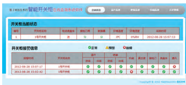
图2 智能开关柜在线监测Web浏览系统的首页
