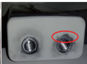
图10 树脂绝缘支撑件螺孔 放电情况
