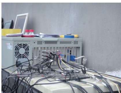
图2 现场试验数据采集系统
