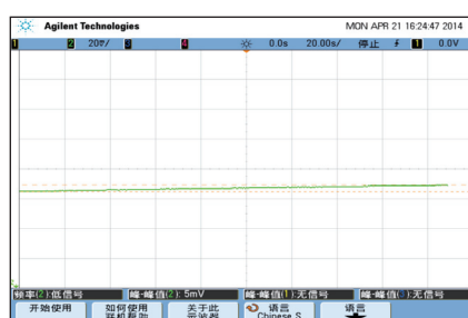
图7 发电模块1对10 F超级电容器的充电效果
